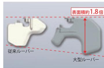
ルーバーは、サイズ形状の見直しにより、従来よりも表面積が約1.8倍にアップ。これにより、左右独立スイングの方向制御性を高めました。
