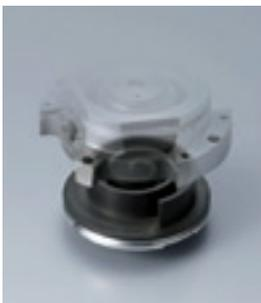
2枚の羽をなめらかに回転させるスクロールコンプレッサーを採用することで運転効率を高め低振動・低騒音も達成しています。また、ネオジ磁石による強力な磁気エネルギーを発生するモーターの採用により冷媒ガス圧縮時の損失を抑えながら高効率・高出力も実現しています。
